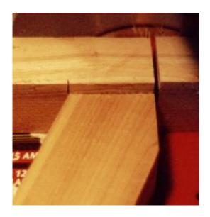
11) NEXT MARK THE LEG 1 1/4" FROM EACH CUT OF THE TOP OF THE LEG AS SHOWN IN THE PICTURE.
