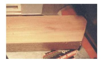
07) NEXT SET YOUR SAW UP TO MAKE A STRAIGHT CUT. TAKE A PIECE OF SCRAP WOOD AND CLAMP IT TO THE FENCE OF THE SAW AS SHOWN IN THE PICTURE.
