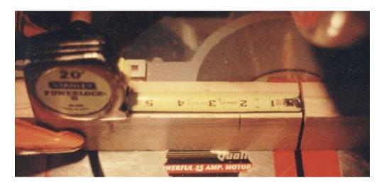
09) SET THE UN-NIPPED END OF THE LEG UP TO THE MARK ON THE FENCE AS SHOWN IN THE PICTURE.
