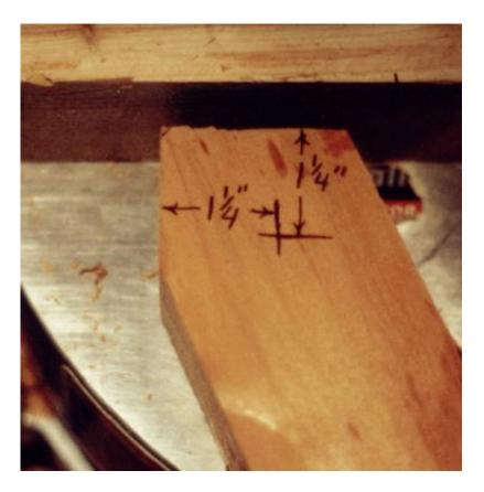
12) SET UP A STOPPER FOR THE DRILL PRESS, AND ALIGN THE 3/8" DRILL BIT WITH YOUR MARK AS SHOWN IN THE PICTURE. DRILL ALL 4 LEGS.
